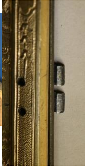
Abb. 9. Verborgener Verschlussmechanismus im Gehäuse. Zwei Stifte müssen gleichzeitig in die rechts gezeigten Löcher eingeführt werden, um die Frontplatte zu öffnen, genau wie beim oben gezeigten Schloss.
