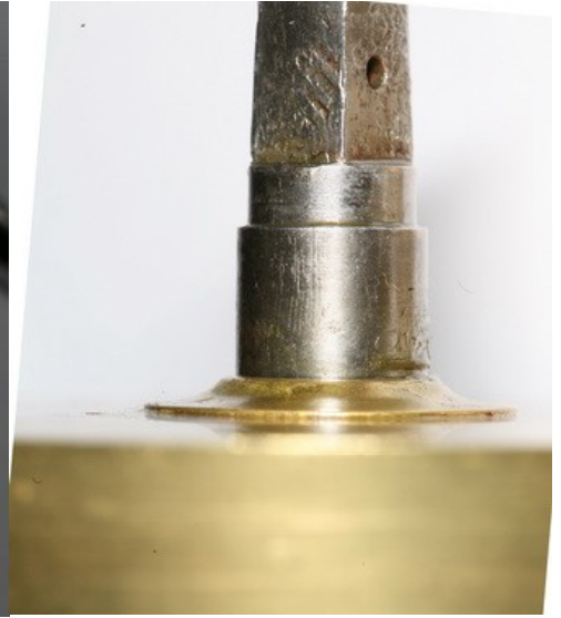
Abb. 56. Das Federhaus ist mit erhabenen Lagern verarbeitet.
