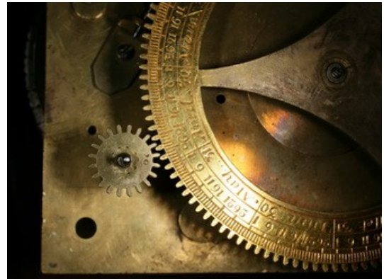
Abb. 46. Der Zeigermechanismus der Zeitgleichung ist unkompliziert und geschickt; er besteht aus einem freidrehenden zentralen Rad "A" mit einer Welle für den Gleichungszeiger mit einer schneckenartigen Kette. Ein Ende der Kette ist am Gleichungshebel befestigt, das andere am Federhaus mit Spiralfeder, ähnlich dem Federhaus in Fusee-Uhren. So wird die Rotation des Rades "A" ganz und gar von der Gleichungsnocke
