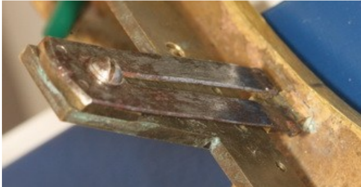
Abb. 9. Verborgener Verschlussmechanismus im Gehäuse. Zwei Stifte müssen gleichzeitig in die rechts gezeigten Löcher eingeführt werden, um die Frontplatte zu öffnen, genau wie beim oben gezeigten Schloss.
