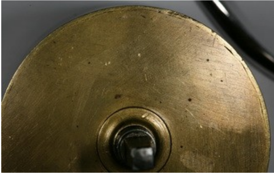
Abb. 55. Das Federhaus besteht aus 2 Teilen: die Wand aus gelötetem Messingband, der Boden als Polygon geschnitten und gelötet.
