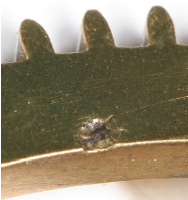
Abb. 57. Gusslöcher sind bei den meisten der Messingteile zu erkennen.
