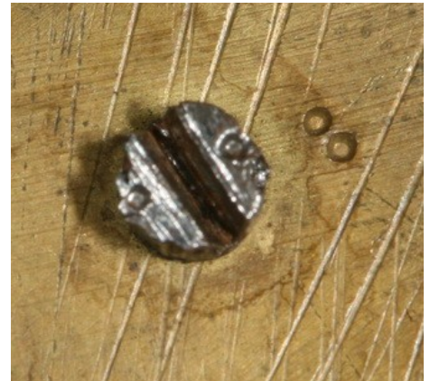
Abb. 58. Einige der Schrauben weisen Punkte auf, die denen der Gewindelöcher entsprechen.
