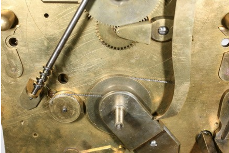
Abb. 46. Der Zeigermechanismus der Zeitgleichung ist unkompliziert und geschickt; er besteht aus einem freidrehenden zentralen Rad "A" mit einer Welle für den Gleichungszeiger mit einer schneckenartigen Kette. Ein Ende der Kette ist am Gleichungshebel befestigt, das andere am Federhaus mit Spiralfeder, ähnlich dem Federhaus in Fusee-Uhren. So wird die Rotation des Rades "A" ganz und gar von der Gleichungsnocke
