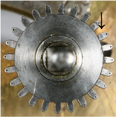
Abb. 51. Das Aufzugrad weist Markierungen an jedem Zahn auf; es wurde wohl manuell eingeteilt und geschnitten. Siehe auch Abb. 15.
