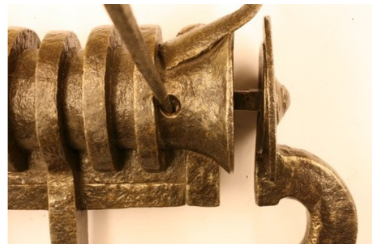
Abb. 8B Verborgene Federn verbinden beide Teile. Beidseitig muß ein Stift eingeführt werden, um die Federn zu lösen. Das gleiche Prinzip ist bei der Huygens-Uhr vorhanden.
