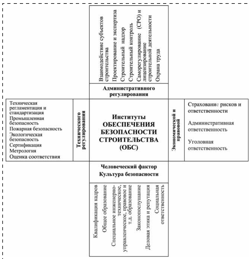
Рис. 2. Институциональная матрица обеспечения безопасности строительства
