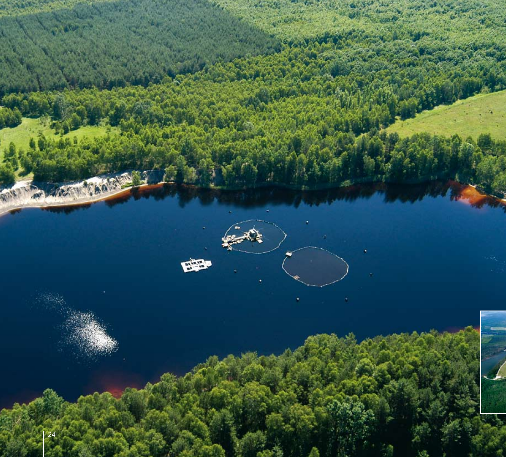
Versuchsanlage mit Groß-Enclosures zur Verbesserung der Wasserqualität im Restloch 111, 2005
