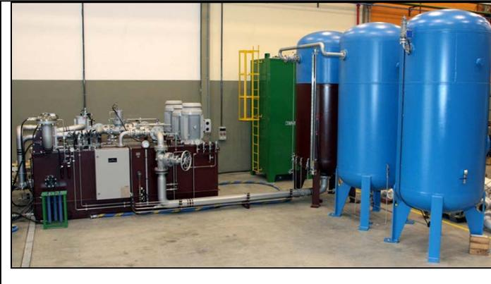
Turbinensteuerung, da sie die Drehzahl reguliert. Auch hier kommen Schraubenspindelpumpen zum Einsatz, die Öl mit 68 bar in die Stellantriebe an den Schaufeln pressen.
