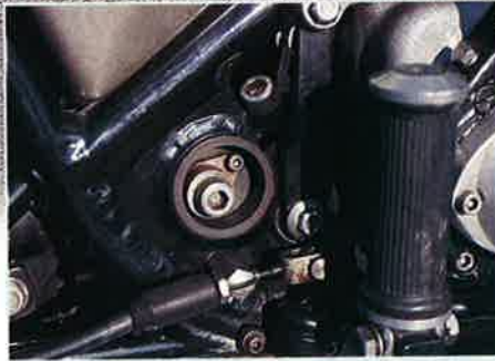
Exzentrische Schwingenlagerung in bester britischer Sportmaschinen-tradition
