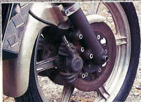
Made in Britain: Ceriani-Nachbaugabel und Lockheed-Bremssättel auf Spondon-Scheiben
