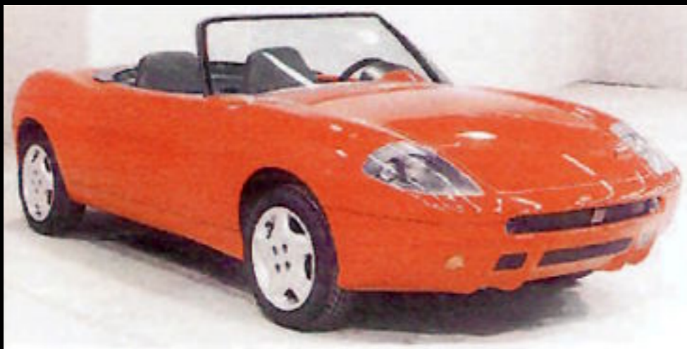
The second clay model of the Marinara , with the altered traffic lanterns in front and behind the well-known square-lanterns Das zweite Tonmodell der Marinara mit modifizierten Frontscheinwerfern und den bekannten eckigen Rückleuchten
