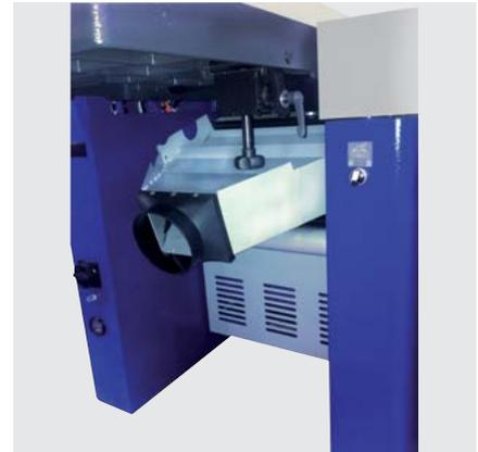
Der Zugriff zum unteren Teil der Messerwelle muss verhindert werden, z. B. durch die unten angebrachte elektrisch verriegelte Absaughaube
