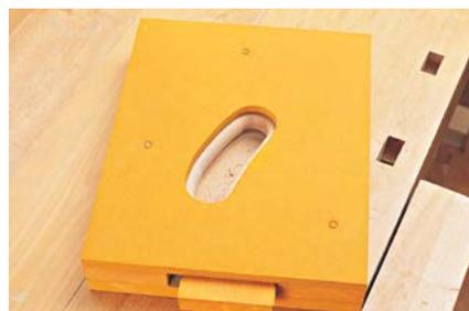
Frässhablone mit eingearbeiteter Kontur auf Grundplatte auflegen. Diese muss formschlüssig (z. B. durch Dübel) auf der Grundplatte fixiert werden.
