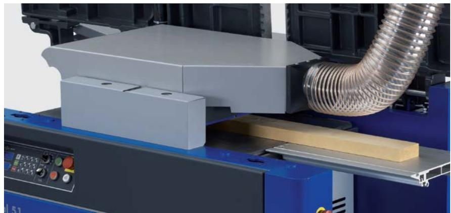
Beim Dickenhobeln muss der Zugriff zum oberen Teil der Messerwelle verhindert werden, z. B. durch die Absaughaube. Wenn die Abrichttische in die senkrechte Position geschwenkt werden, müssen diese gegen Kippen gesichert werden.
