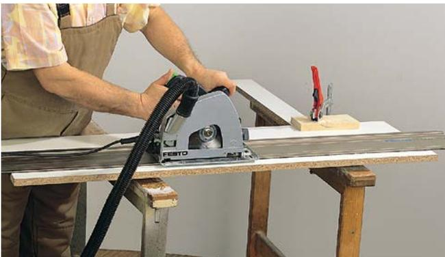
Kreissägeblatt für Plattenmaterial wählen (z. B. vielzahniges HM-Wechselzahn-Sägeblatt).
