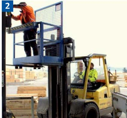
Instandhaltungsarbeiten mit Gabelstapler und Arbeitsbühne.
