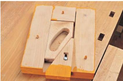
Werkstück in Schablonengrundplatte einlegen und mit einem eingeneteten Schieber (z. B. T-Nut) auf der Hobelbank mit Bankhaken spannen.
