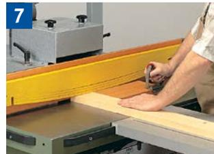
7 Fräsen von Querseiten mit durchgehendem Anschlag, Bogenfeder und Schiebeholz.
