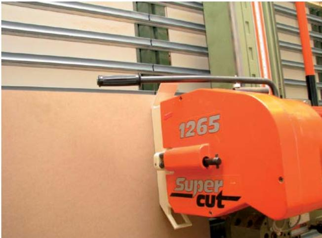
Selbsttätig schließende Sägeblattverkleidung
