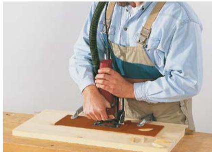
Beim Harzgallenausfräsen Maschine mit beiden Händen führen.
