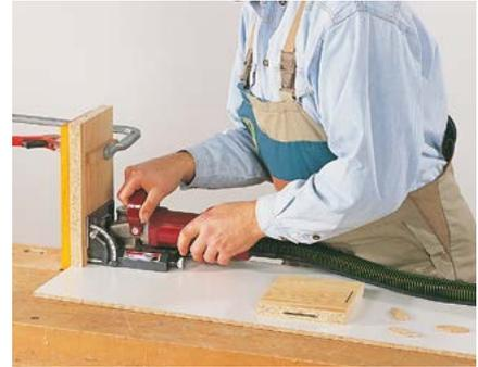
Werkstück bei stehender Bearbeitung durch Stützwinkel sichern.
