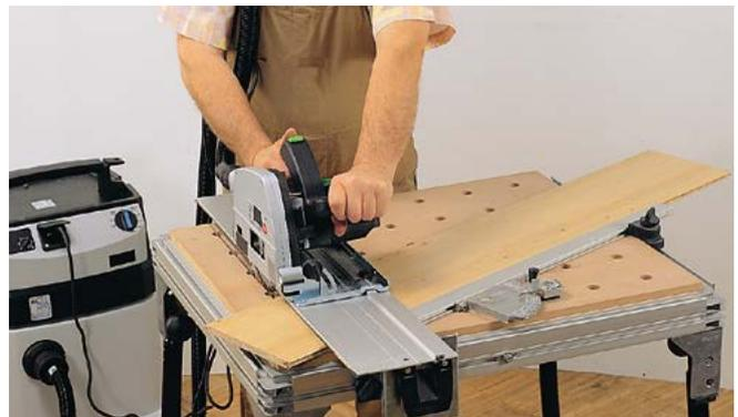
Für Montageschnitte beim Innenausbau geeignete Arbeitsvorrichtungen zur sicheren Werkstückauflage und präzisen Werkzeugführung benutzen.
