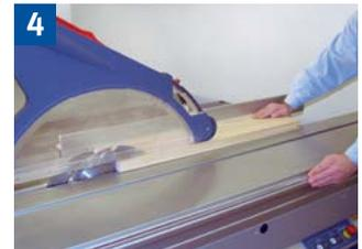
4 Längssägen von Breite mit der Hand (Breite über 120 mm).
