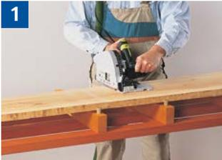
1 Sägen von Massivholz auf Unterlagen mit Anschlagknoppen.
