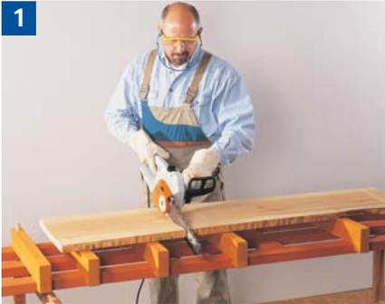
Beim Ablängen von Brettware im Werkstattbereich auf sicheren Stand und auf sichere Auflage achten. Durch eine zusätzliche Unterlage muss ein unkontrolliertes Durchtauchen/Schneiden der Kettensägemaschine verhindert werden. Die Schienenspitze darf keine anderen Werkstücke berühren.
