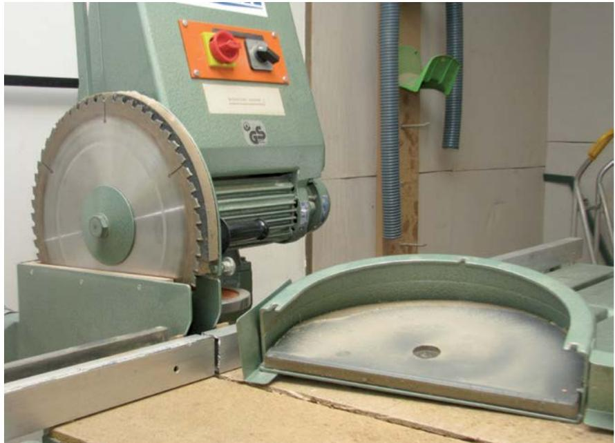
Sägeblattverkleidung mit schallabsorbierender Auskleidung
