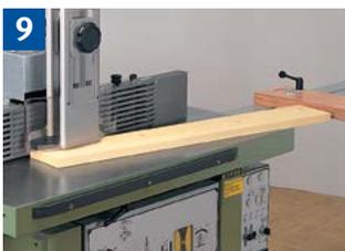
9 Einsetzfräsen großer Werkstücke mit Rückschlagsicherung.
