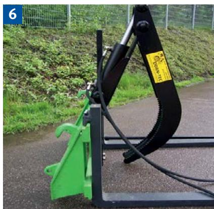
Gabelstapler mit Zangengreifer zum Transport von Rundholz.
