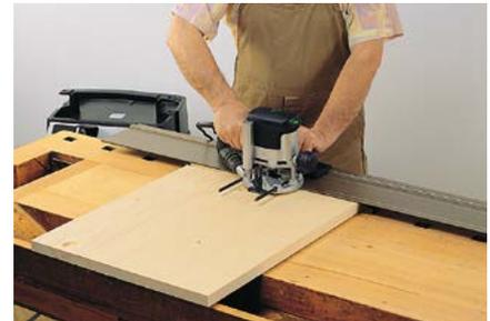
Werkstück gegen Verschieben sichern. Führungsschiene oder Schablone auf dem Werkstück befestigen. Maschine mit dem Frästisch auf Führungsschiene aufsetzen.
