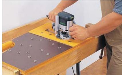
Stabile und abriebfeste Schablonenkanten vorsehen. Geeignet sind z. B. Multiplexplatten oder mit Massivholzanleimern oder Kunststoffkanten beschichtete Führungskanten. Bei Bohrschablonen Buchsen einsetzen. Gute Gleitfähigkeit auf dem Maschinentisch sicherstellen, z. B. durch einen Belag mit niedrigem Reibwert. Schablonengewicht an den Arbeitsgang anpassen:
