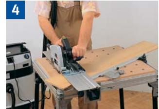
4 Bei Montageschnitten für sichere Werkstückauflage und präzise Werkzeugführung sorgen.
