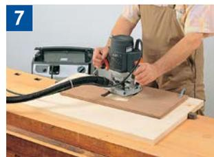
7 Einsatz der Handoberfräsmaschine mit Schablone.
