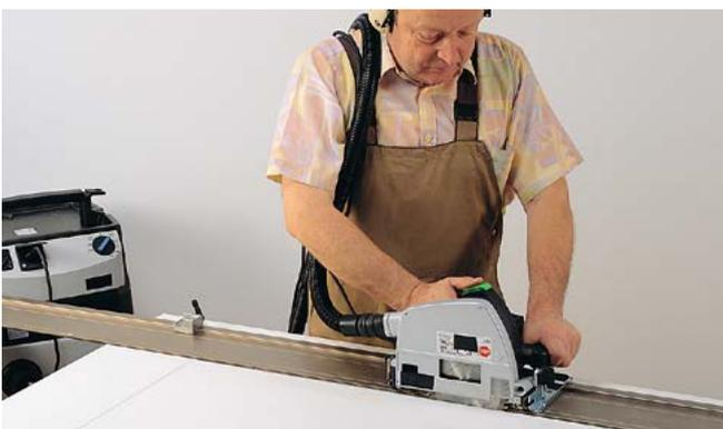
Werden Handkreissägemaschinen stationär in Tische eingebaut, sind die Anforderungen an Tisch- und Formatkreissägemaschinen zu beachten.
