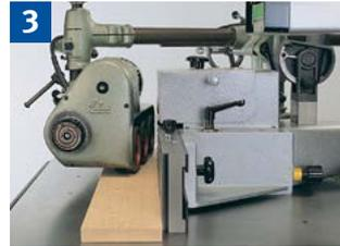
3 Fräsen von geraden Werkstücken am Anschlag mit Vorschubapparat.
