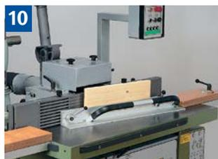
10 Einsetzfräsen kleiner Werkstücke mit Spannlade und Rückschlagsicherung.
