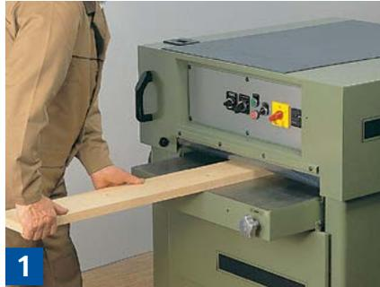
**1** Hobeln breiter Werkstücke. Durch mehrere Hobelvorgänge das Endmaß herstellen.
