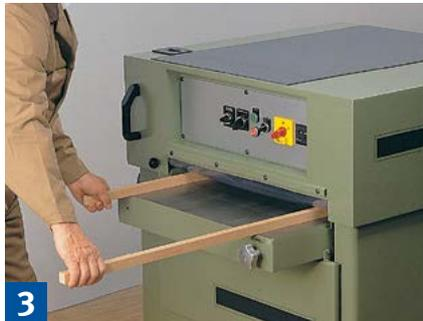
**3** Hobeln schmaler Werkstücke. Bei starren Einzugswalzen und Druckbalken maximal zwei Werkstücke gleichzeitig bearbeiten.
