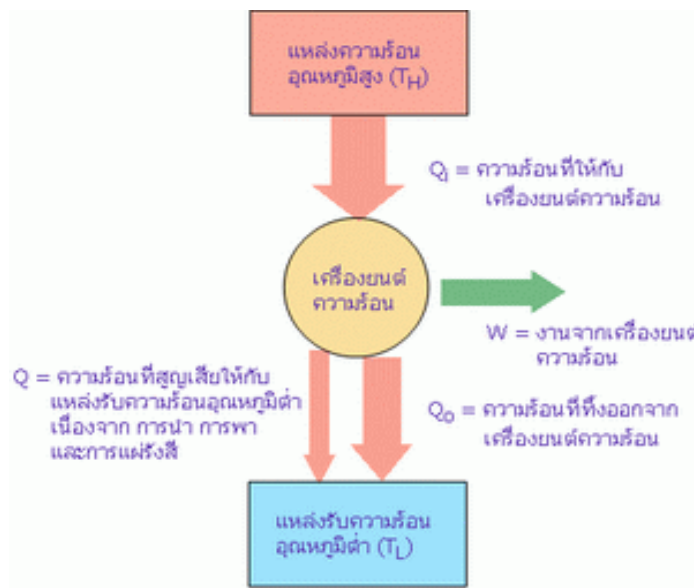
รูปที่ 2 แผนภาพเครื่องยนต์ความร้อน
