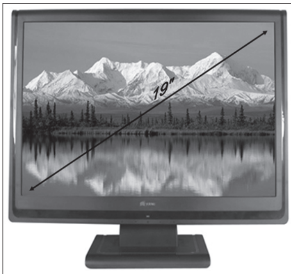
Bild 2: Diagonale eines Monitors in Zoll
