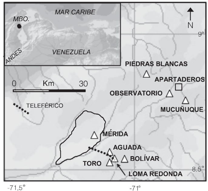
Figura 1. Sitios GPS (triángulos) que conformaron la Campaña GPS Bolívar 2002 para determinar las elevaciones del Pico Bolívar y otras cimas aledañas en los Andes Venezolanos. El sitio Observatorio es el punto de referencia local utilizado para derivar las coordenadas precisas y alturas elipsoidales de los demás puntos, en el sistema ITRF2000, época 2002.1, WGS84. Las antenas receptoras fueron colocadas en cada uno de los topos de las cimas estudiadas.
