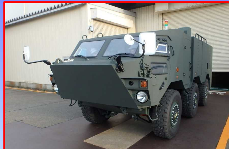
※NBC偵察車をベースとした評価用車両 機動性能検証用車両
