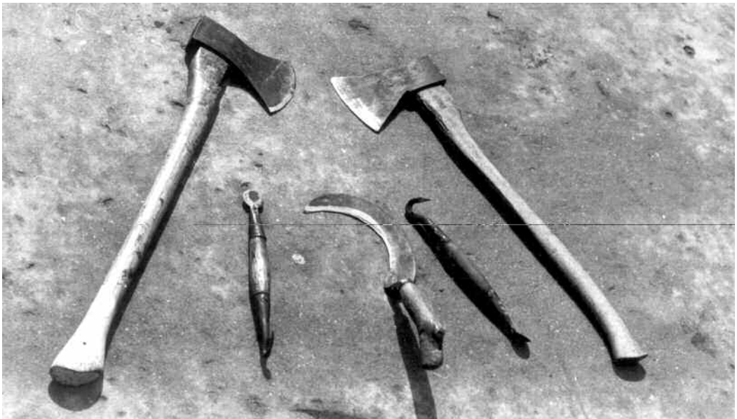
Foto 4.2.4: Arbeitsgeräte der Waldnachbarschaft (von links nach rechts): Axt, Lohmesser, Strengelmetz, Lohmesser, Axt.
