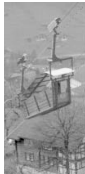
Cabina Rotair de 65 pasajeros en el Teleférico de Table Mountain (Sudáfrica). Fabricantes: CWA (cabinas), Garaventa (instalación)
