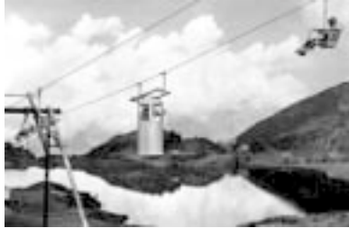
Silla y cabina en un teleférico monocable
