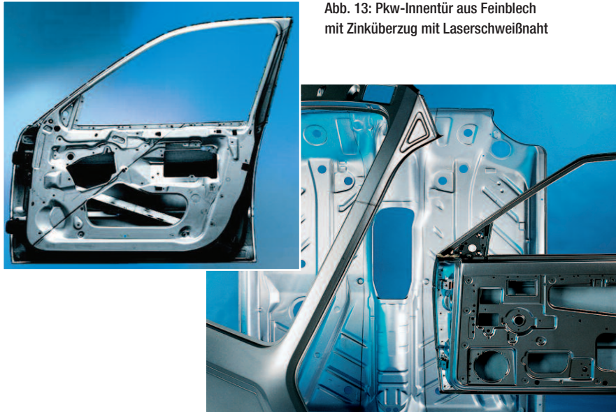
Abb. 14: Karosserieteile, zum Teil lasergeschweißt, aus Feinblechen mit Zinküberzug
