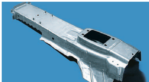
Abb. 14: Karosserieteile, zum Teil lasergeschweißt, aus Feinblechen mit Zinküberzug
