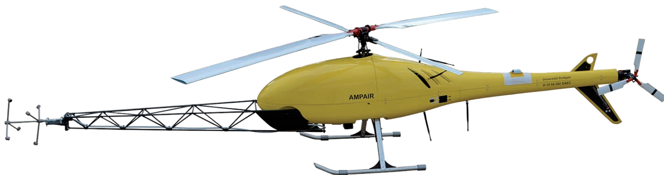
Abbildung 1: Trägersystem „AMPAIR“ des Instituts für Flugzeugbau der Universität Stuttgart mit Messausleger © USTUTT
