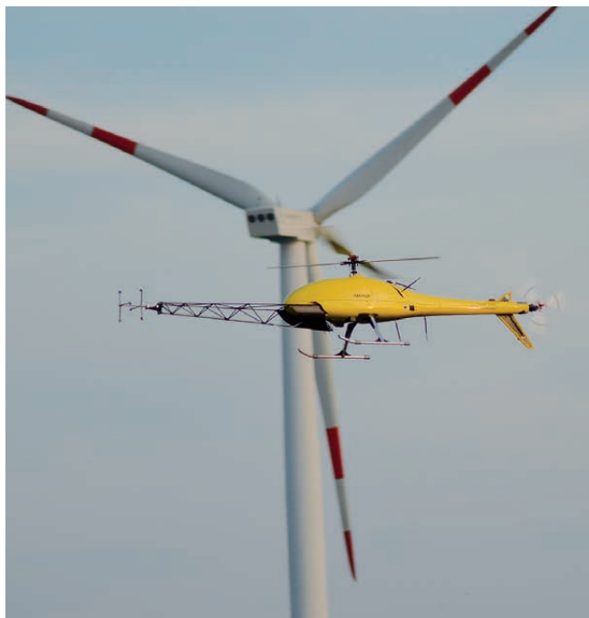
Abbildung 2: AMPAIR im Messflug vor WEA © USTUTT
