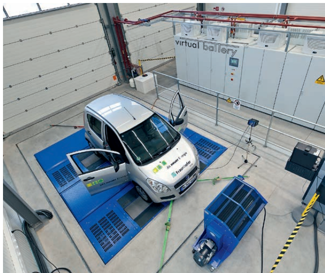
Rollenprüfstand für Elektromobilität des Fraunhofer IWES, © Fraunhofer IWES
