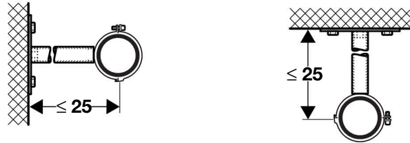
Bild 475: Die Fixpunkte werden bis 25 cm Decken- oder Wandabstand mit der Rohrschellenbefestigung 1/2" und der Grundplatte 362.851.26.1 ausgeführt
