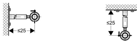
Bild 341: Fixpunkte bis 25 cm Wand- oder Deckenabstand mit der Rohrschellenbefestigung 1/2" und der Grundplatte 362.851.26.1
