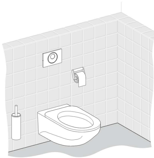
Bild 143: Geberit WC-Steuerung berührungslos
