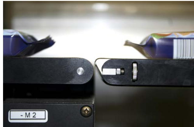
Das Messerkantenband minimiert den Abstand zwischen zwei Bändern, somit lassen sich Produkte „weicher“ übergeben.
