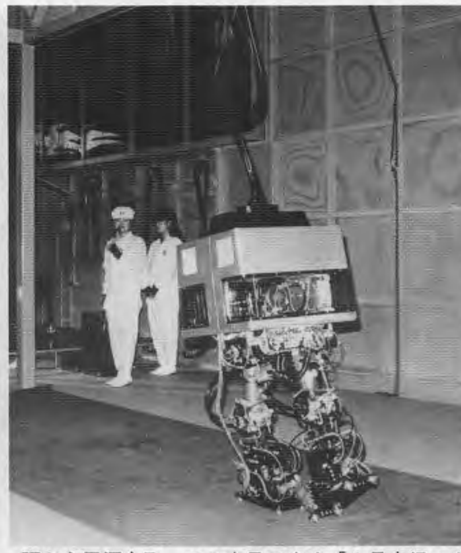
頭から電源を取って2本足で歩く「2足走行ロボット」(加藤一郎早大教授らの設計)
