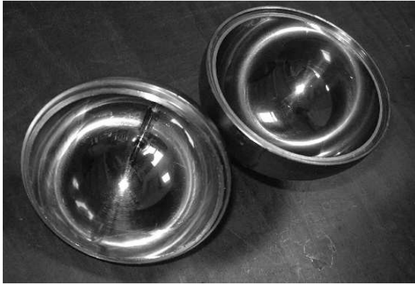
Abbildung 7: Werkzeug zur Herstellung des Ballrohlings [9]
