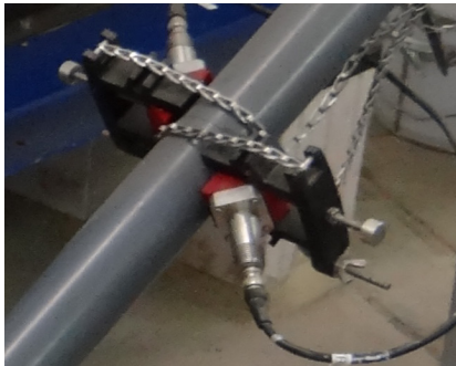
Abbildung 16: Durchflussmesser (DigitalFlow DF868) zur Durchflussmessung im hydraulischen Modell [links] und die technischen Merkmale [rechts]
