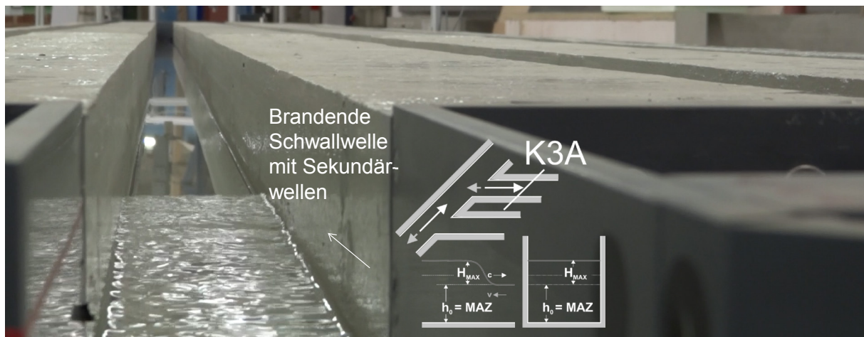
Abbildung 46: Brandende Schwallwelle im hydraulischen Modell
