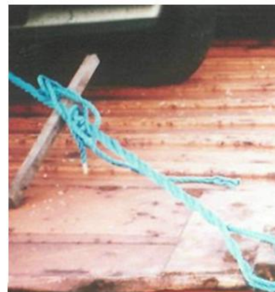
Automobil učvršćen sa "Hercules" konopom
