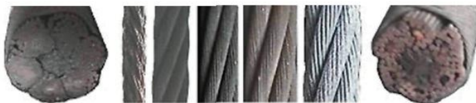
Različita struktura čeličnog konopa – poprečni presjek i uzdužni pogled
