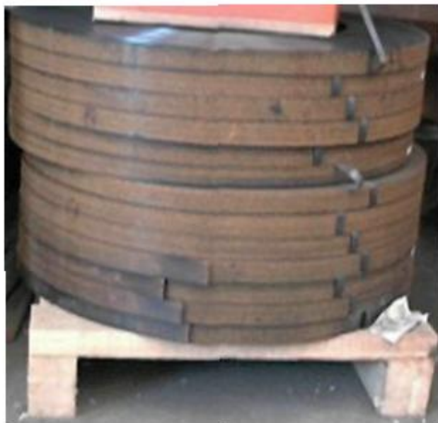
Netretirane čelične treke za osiguranje ( Steel strapping untreated )
