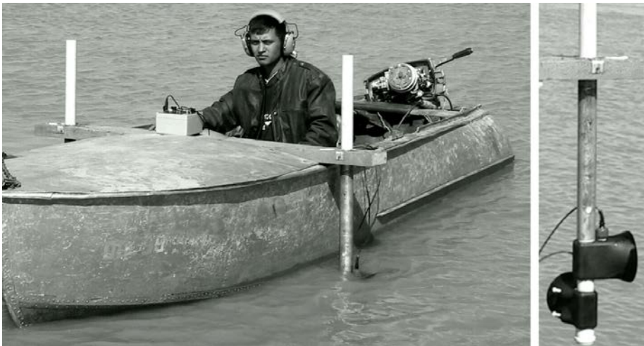
Рис. 3. Лодка, оснащенная оборудованием и приборами для обнаружения и идентификации сигналов от лопатоносов с имплантированными акустическими ИВТ-метками; справа показана часть подвески с гидрофонами
