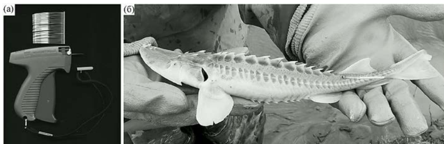
Рис. 1. Пистолет-инжектор с кассетой пластиковых меток (а) и повторно пойманный в р. Амударье лопатонос с меткой под спинным плавником (б)
