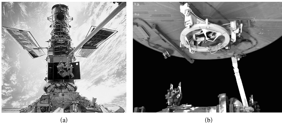
图 1.2 维修中的哈勃望远镜及其最新配置的对接机构
