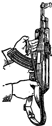
Рис. 55. Откидывание складывающегося приклада
