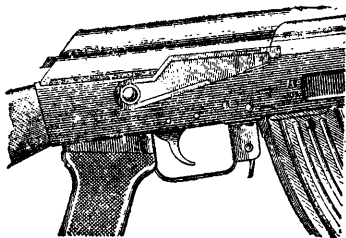
Рис. 53. Автомат поставлен на предохранитель
