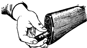
Рис. 10. Вкладывание пена- нала в гнездо приклада
