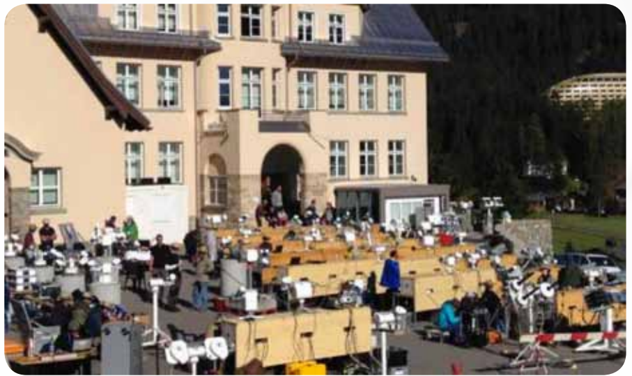
Despliegue de distintos tipos de radiómetros en la intercomparación de Davos (Suiza)
