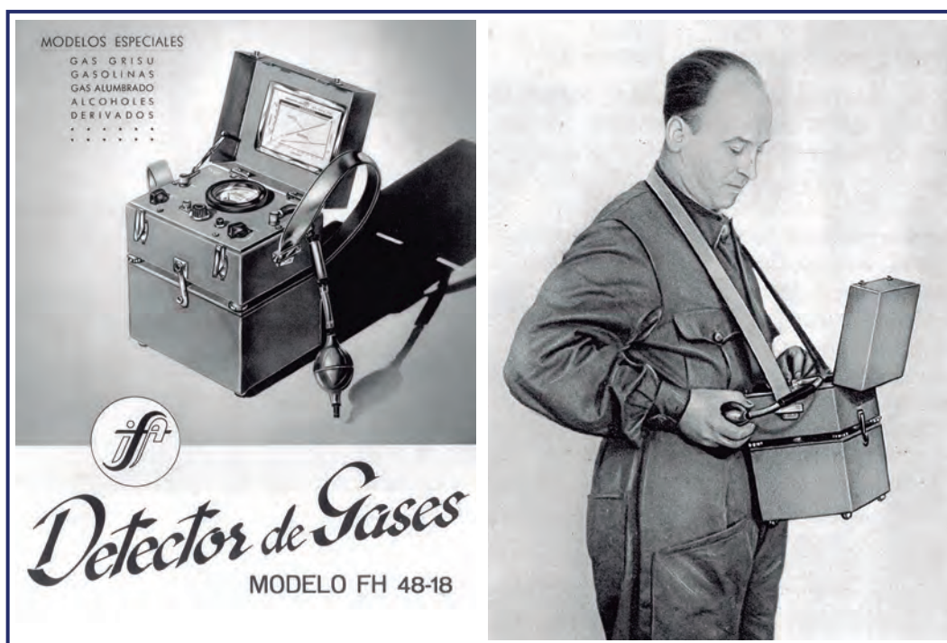
Figuras 8 y 9. Imagen izquierda, detector de grisú portátil, modelo FH 48-18, diseñado en el Laboratorio de geofísica del Instituto en 1948. Imagen derecha, manera de llevar colocado el detector de gases modelo FH 48-18, en el que puede apreciarse su pequeño tamaño y comodidad para el operador, que queda en gran libertad de movimiento
