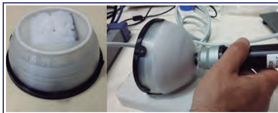
Figura 8. Simulador físico de una cabeza de neonato, a la izquierda se representa la estructura interna de la misma y a la derecha un ensayo de exploración, ya con el simulador completamente montado (estructuras rígidas, simuladores de cerebro, membrana y LCR) con la sonda de ultrasonidos acoplada en la "ventana" de la fontanela"
