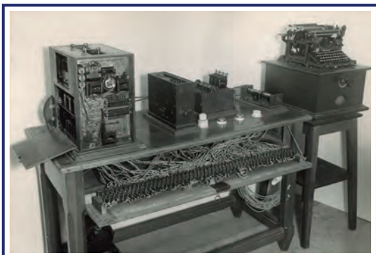
Figura 12. El Aritmómetro electromecánico de 1920 mostrando sus diferentes componentes
