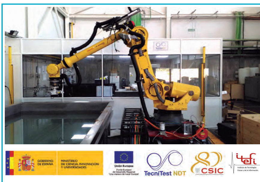
Figura 2. Sistema de inspección en TecniTest Proyecto GENUSROB
