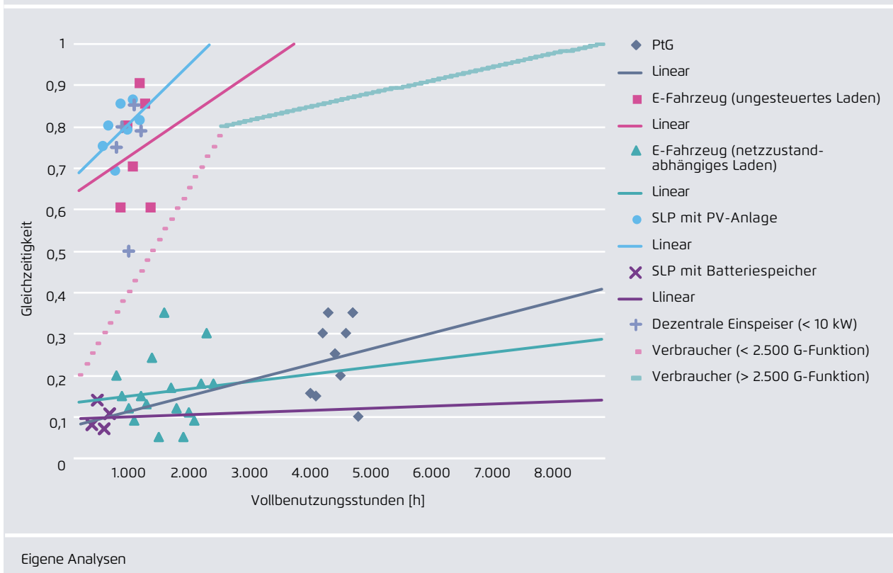
Beispielhafte Differenzierung von Gleichzeitigkeitsfunktionen
