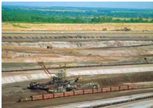
Schaufelradbagger SRs 1200-1431 bei der Beladung eines Kohlenzuges im Tagebau Profen, 1995 Werbener See, 2016 Aktiver Tagebau Profen, 2008
