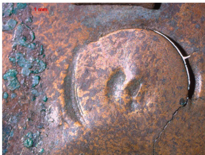
Рис. 2. Брак при нанесении тисненого орнамента.
