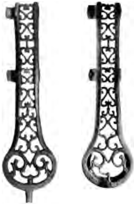
Abb. 68: Niedergösgen SO. Patrizie GK 9 des Typs 2 Niedergösgen mit Zapfen für das Eingussloch der Lehmform und nicht durchlochtem Nietlappen. M. 1:2.
