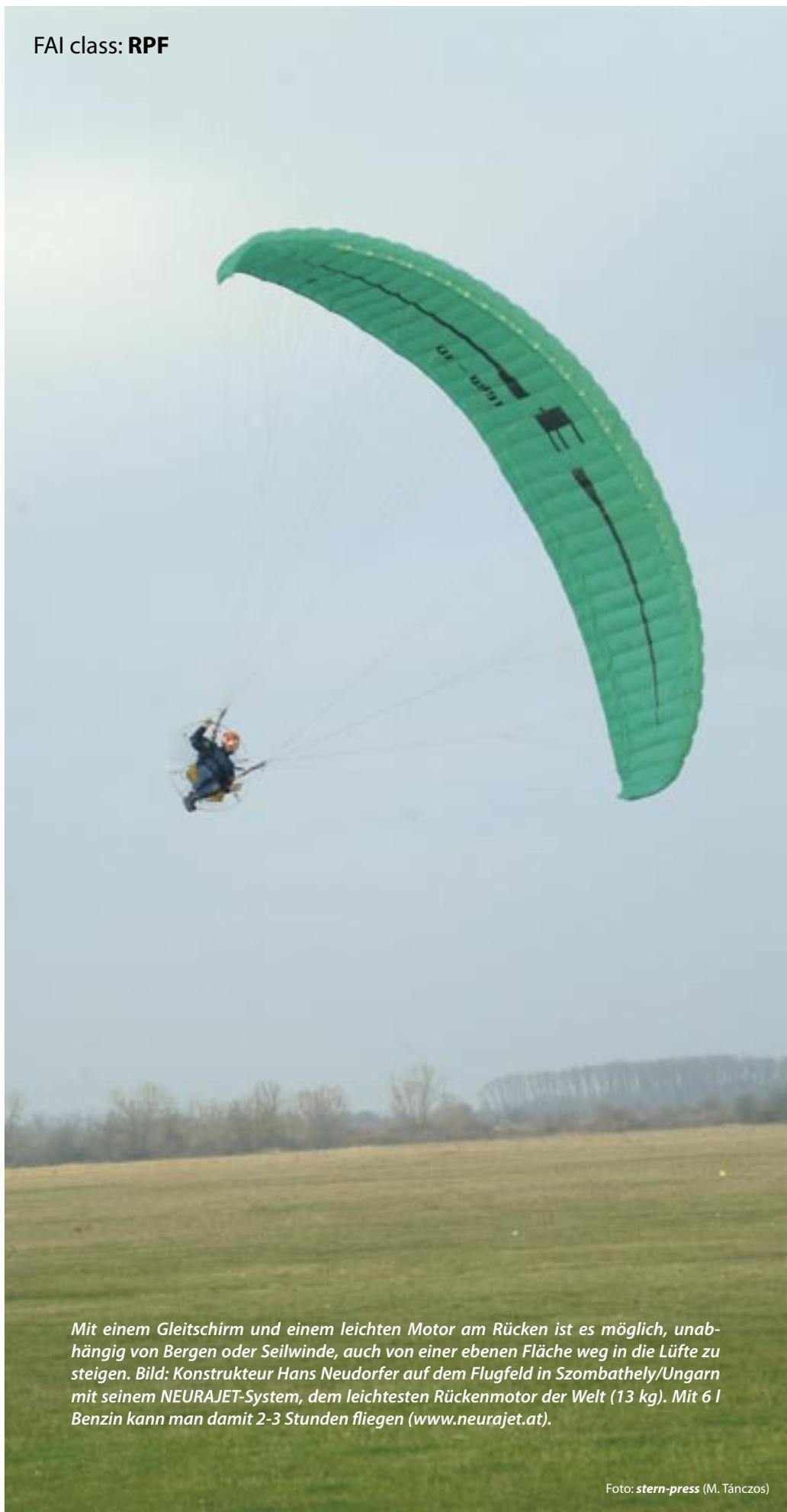
*Mit einem Gleitschirm und einem leichten Motor am Rücken ist es möglich, unabhängig von Bergen oder Seilwinde, auch von einer ebenen Fläche weg in die Lüfte zu steigen. Bild: Konstrukteur Hans Neudorfer auf dem Flugfeld in Szombathely/Ungarn mit seinem NEURAJET-System, dem leichtesten Rückenmotor der Welt (13 kg). Mit 6 l Benzin kann man damit 2-3 Stunden fliegen ([www.neurajet.at](http://www.neurajet.at)).*
