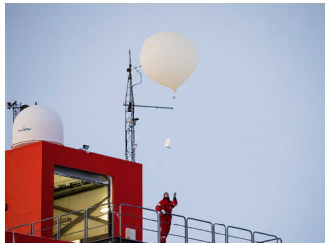
Ozonsondenstart an der Neumayer III Station
