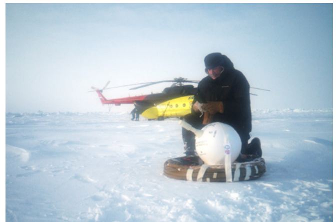
Auslegung einer meteorologischen Boje für YOPP nahe dem Nordpol Foto: AARI / T. Petrovsky
