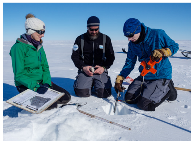
Manuelle Messung der Schnee- und Eisdicke Foto: AWI / J. Rohde
