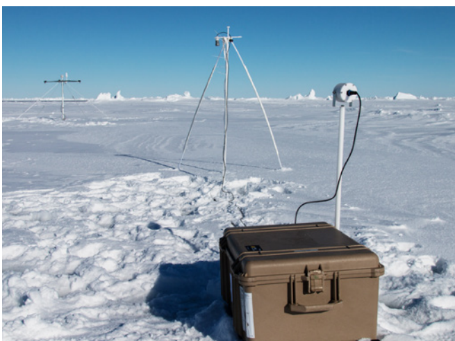
Autonome Messungen. Thermistorketten- (vorne) und Schnee-Boje (hinten links) zur Bestimmung der Eis- und Schneedicke Foto: AWI / S. Arndt
