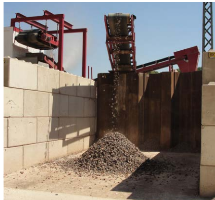
R-Beton in der Zukunft: Durch den Einsatz mobiler Aufbereitungsanlagen könnten rezyklierte Gesteinskörnungen auf kurzen Wegen in die Transportbetonwerke gelangen. Dort wo regionale Aufbereitungsanlagen zur Verfügung stehen, ist dies heute schon möglich.
