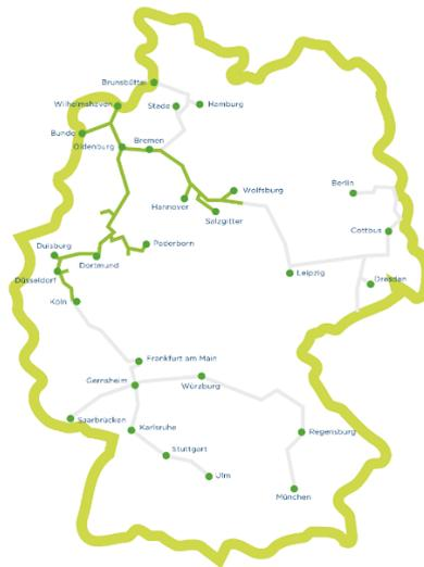
**Abbildung 6:** Kartenskizze des geplanten CO<sub>2</sub>-Rohrleitungsnetzes (grün) und möglicher Erweiterungen (grau). (OGE, 2022)
