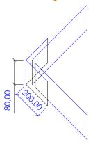
Empalme en esquina en zuncho de coronación de muro a base de laminado de fibra de carbono, mediante adhesión de pieza especial preformada compuesta a base de fibra de carbono. La adhesión de las piezas se realiza, previa limpieza con acetona, mediante adhesivo epoxi estructural de consistencia pastosa MBRACE RESIN 220. Las dimensiones en sección son idénticas al laminado insertado en roza (Mbrace Laminado LM 80/1.4), con radios de curvatura de 4 cm y longitudes de solape superiores a 200 mm.
