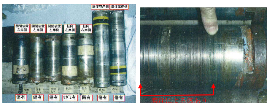
図 3-5-7 機能低下の事例（滑車の軸受けの磨耗）
