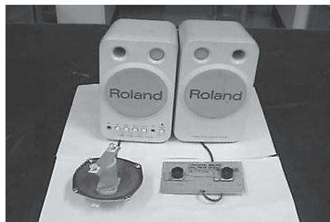
図 7 パソコンとスピーカー利用のマルチストロボ(増幅器付きスピーカーに 1W 白色 LED とスピーカー利用水波用波源を接続する)
