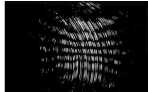
図 13 スピーカーと垂直な平面での干渉模様
