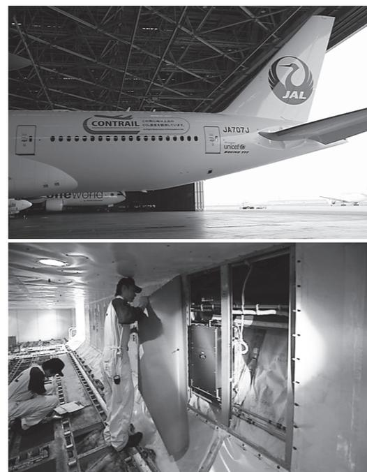
図5 (上)CONTRAILプロジェクトのロゴが塗装されたJALのボーイング777機。(下)ボーイング777機の前方貨物室の壁の中にCO<sub>2</sub>高頻度観測装置が設置されている(CONTRAILホームページ <http://www.cger.nies.go.jp/contrail/> より)。
