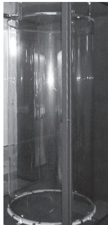
図2 ラバース式機械吹きガラス円筒 (旭硝子(株)研修センター)
