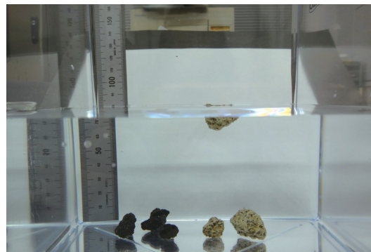
図9 水槽の底に沈んだスコリアと軽石。富士火山1707年噴火のスコリアは、着水後すみやかに沈んだ。浅間火山1783年噴火の軽石は、泡を出しながら水を吸って次第に沈んだ。写真中で浮いている粒子もやがて完全に沈んだ。
