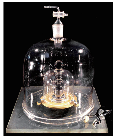
図1 1889年に質量の単位として定義された国際キログラム原器(IPK) 白金90%, イリジウム10%から成る合金製の分銅。直径、高さともに約39mmの直円筒型。 写真提供:国際度量衡局(BIPM)
