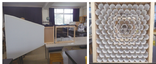
図5 作製した装置(左が風洞装置、右が整流器)
