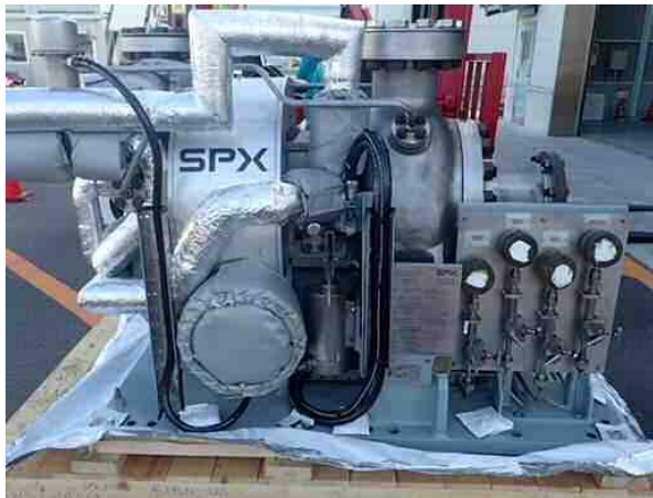
高圧原子炉代替注水ポンプ
