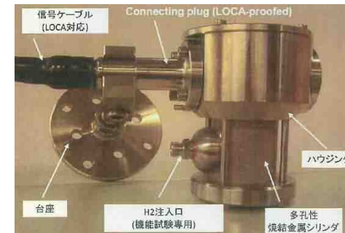
■ : 原子炉建物内水素濃度計
