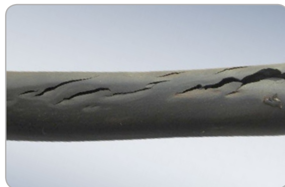
Darstellung eines chemischen Angriffs auf einen O-Ring
