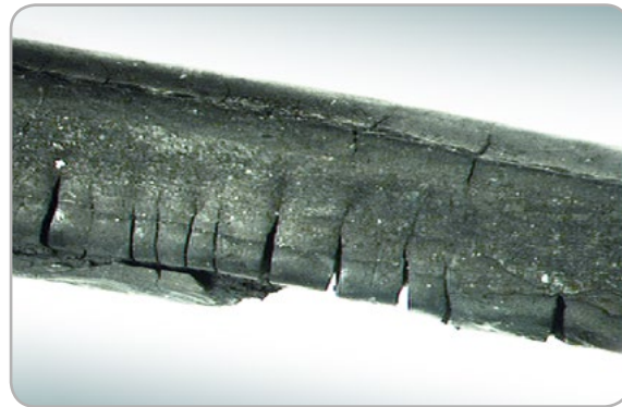
Extrem starker thermischer Angriff auf einen O-Ring
