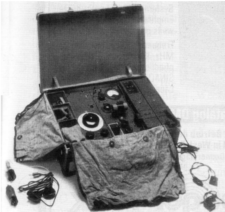
Abb. 64: Englisches Afu-Gerät Type 3 Mk.I mit insg. 6 Steckspulen für den Frequenzbereich von 3,5 bis 17 MHz.
