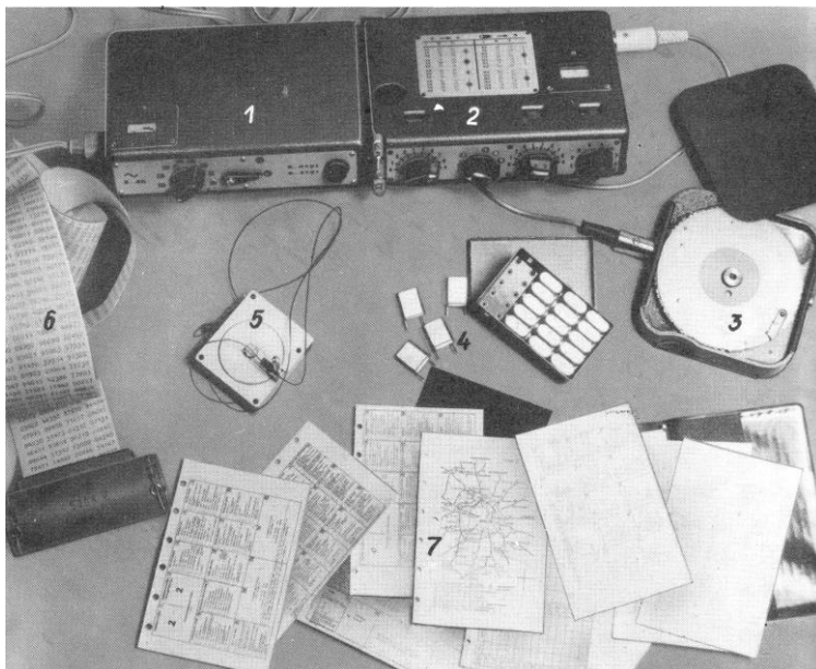
Abb. 101: Vom Bundesnachrichtendienst eingesetzte Kurzwellen-Sendeinrichtung (1: Netzgerät, 2: Sender, 3: Schnellgeber, 4: Steckquarze für den Sender, 5: Antennenhaspel, 6: One-Time-Pad-Schlüsselstreifen, 7: Betriebs- und Arbeitsunterlagen)
