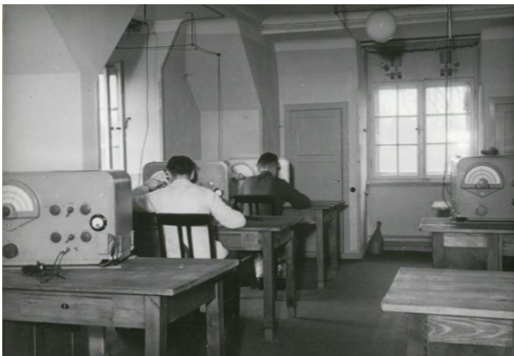
Abb. 16: Platz 10 im Empfangsraum II der "Domäne" mit Siemens R-IV Empfänger und weiterem Spulenkasten (rechts oben auf dem Empfänger) zum schnellen Bandwechsel.
