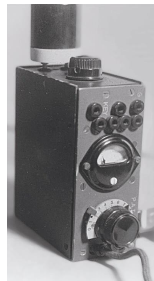
Abb. 70: Empfänger E 98 (links) und Sender S 98/3 (rechts) des Afu-Gerätes SE 98/3 im geöffneten Zustand. Rechts Sender geschlossen und mit eingestecktem Quarz.
