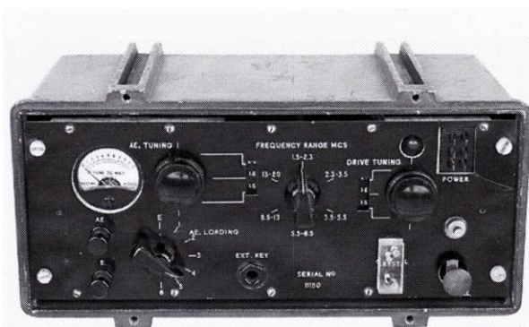
Abb. 83: Englischer Afu-Sender aus der Nachkriegszeit um 1950.
