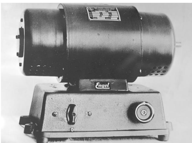
Abb. 99: Einanker Umformer zum Betrieb von 220 V-Wechselspannungs-Afu-Geräten mittlerer Sendeleistung (bis 40 W) an einer Autobatterie.
