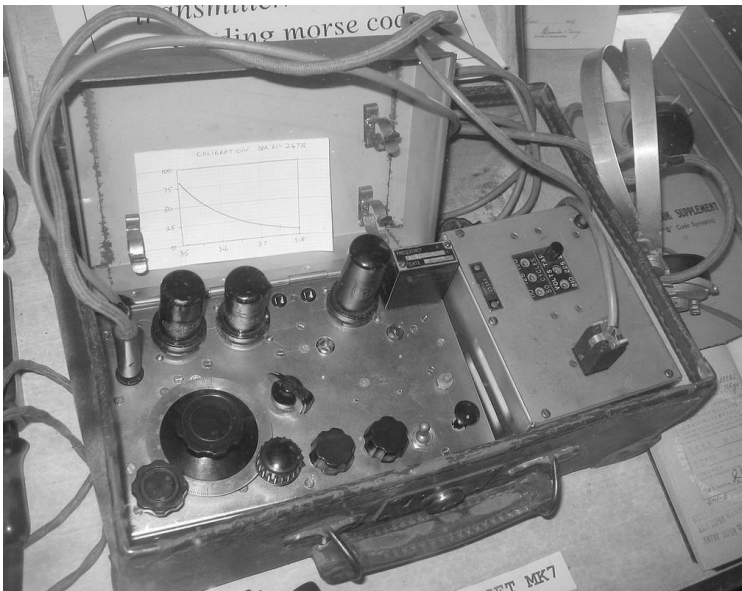
Abb. 45: Englisches Afu-Gerät Mk.VII/B "Paraset". Rechts unten auf der Oberseite ist die eingebaute Morsetaste zu erkennen.
