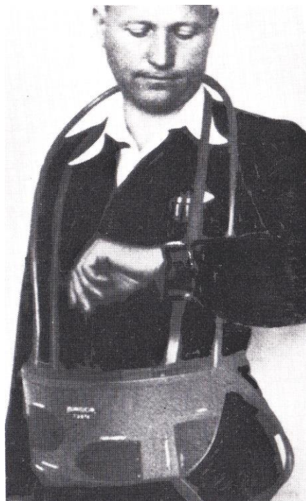
Abb. 117: Umgehängter Gürtelpeiler mit Antennenschlaufe
