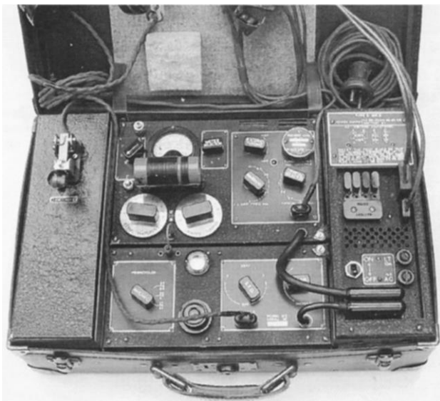
Abb. 65: Englisches Afu-Gerät Type 3 Mk.II mit 4 Steckspulen für den Frequenzbereich von 3,5 bis 16 MHz. Rechts das Zubehör (Steckspulen, Ersatzröhren, Morsetaste usw.)
