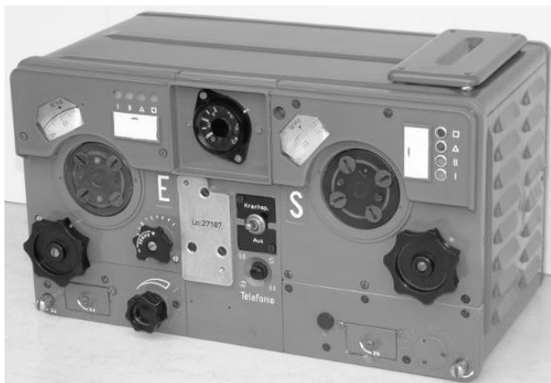
Abb. 102: UKW-Flugzeugfunkgerät FuG 16 (Sendeleistung ca. 10 W, Frequenzbereich 38,5 bis 42,3 MHz)
