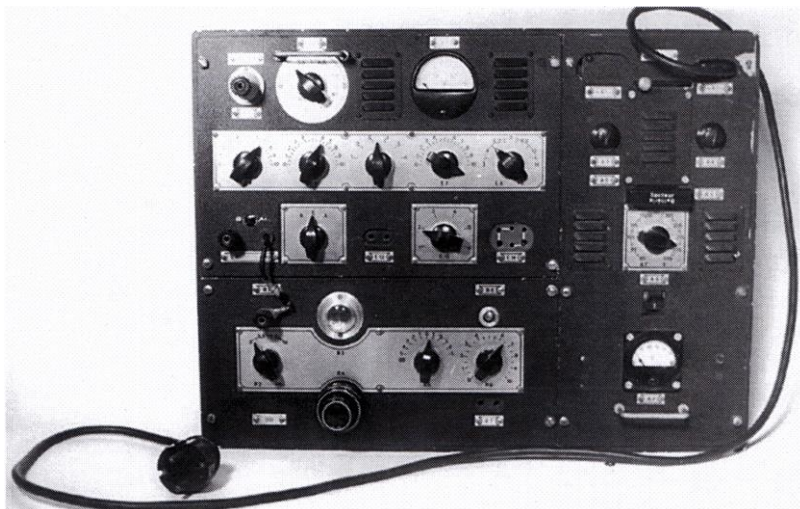
Abb. 85: Von der Firma Telefunken konstruiertes Koffer-Funkgerät aus der Zeit um 1952.
