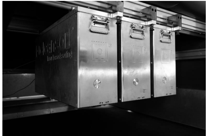
Abbildung 10: links: clean2sort Modul, rechts: Kaskadierung der clean2sort Module im Technikum.
