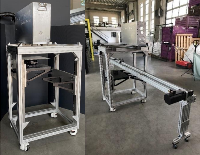
Abbildung 12: links: Messstand mit unterschiedlichen Bearbeitungsabständen, rechts: Messstand mit Linearführung für dynamische Messungen.
