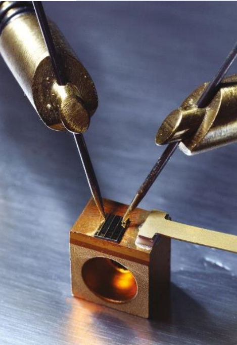
Ein Quantum Cascade Laser auf einem C-Mount wird mit feinen Testspitzen kontaktiert zur erstweiligen Qualitätsprüfung. © Frank Wojciechowsk
